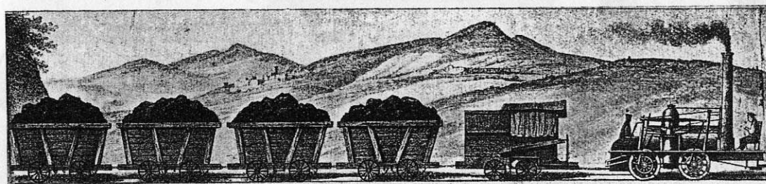
Les premiers trains du chemin de fer de Lyon à Saint-Etienne construit par Marc Séguin. Le train de houille est remorqué par une « Stephenson » perfectionnée par Séguin.
